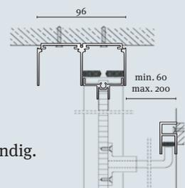
Wird bei Schrägtüren unter einer Dachschräge notwendig.
