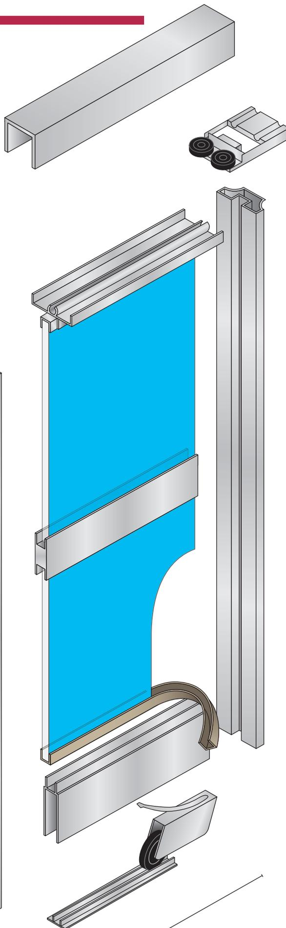
Die oberen Führungsrollen und die untere Laufrolle sind präzisionskugelgelagert.
